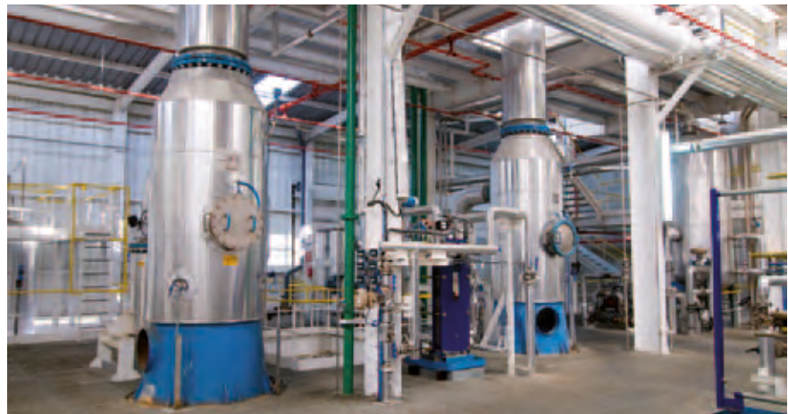
Columnas de Secado de Glicerina y Metanol
