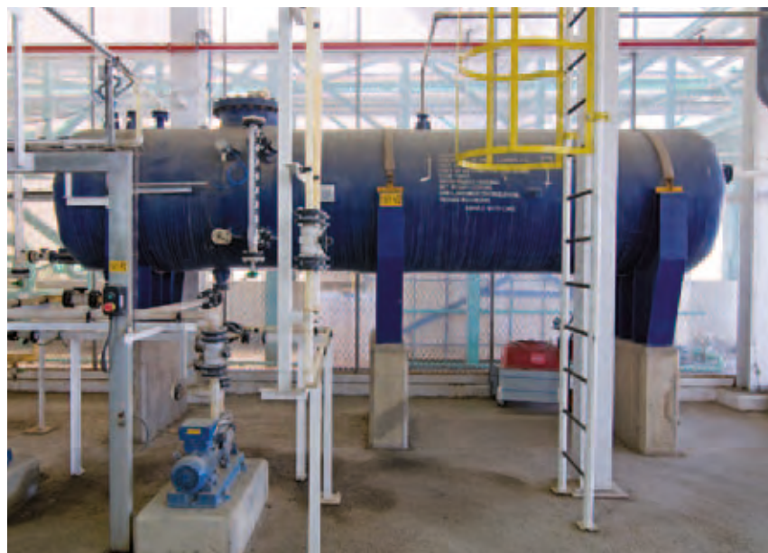
Decantador de Biodiesel Ácido
