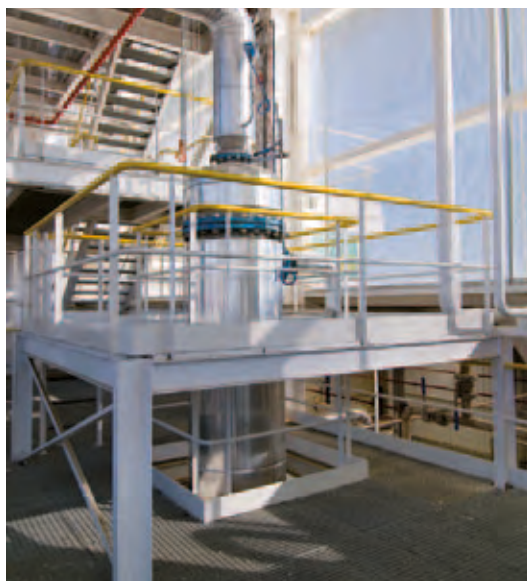
Columna de Secado de Biodiesel
